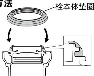
安装栓本体垫圈的时候不可弄错方向，请确实地嵌进深处。
