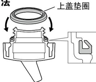
安装上盖垫圈的时候不可弄错方向，请确实地嵌进深处。
