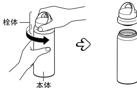
● 请确认上盖垫圈、栓本体垫圈是否安装在栓体上。
