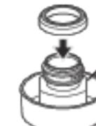
安装栓盖垫圈的时候不可弄错方向，请确实地嵌进深处。
