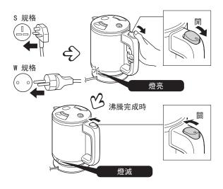
請先確認電源開關是否切換為「關」 後,再將電源插座上的電源插頭拔除。
