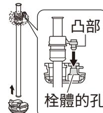
請留意不要弄錯栓體的安裝方向，精準地將栓體嵌入。將凸部對準栓體的孔。
