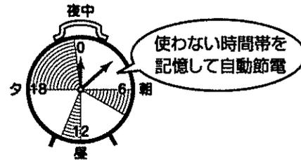
とく子さんコースを選べば、そのときから給湯状況を記憶して使用2日後からは使わない(給湯しない)時間帯は自動的にヒーターへの通電を切るまほうびん保温に切り換わります。
