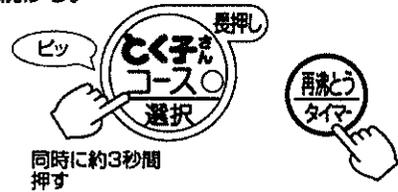
「ピッ」と音がして、洗浄が開始されます。洗浄中は沸とうランプと保温ランプが交互に点滅、液晶表示が下図のように移動して知らせます。その後洗浄の残時間の表示に切り換わります。
