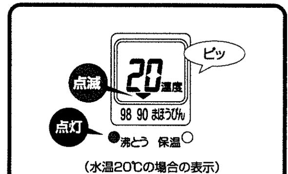
「ピッ」と音がして、沸とうランプが点灯し、▼マークが90保温位置で点滅します。湯わかしが開始されます。
