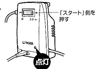
2 希望水位まで給水すると、水位センサーの働きでポンプが自動停止し、ブザーが鳴ります。ブザーが鳴ったら、電源スイッチの「切」側を押す。
