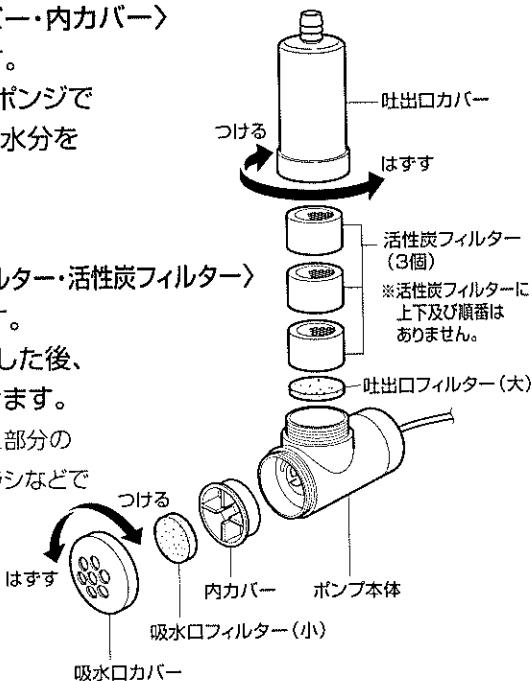
\*カバー・フィルター類は、正しく確実に取りつけてください。カバー・フィルター類を誤って取りつけた状態やはずした状態で使用すると、故障の原因になります。
