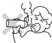
**必ず実施** 飲み物は、できるだけ早く飲みきる。長時間放置した場合、腐敗によりガスが発生し、本体内部の内圧が上がリ、ふたがあかなかったり、内容物が吹き出るおそれ。また、キャップユニットが破損して、飛散する可能性があり危険。
