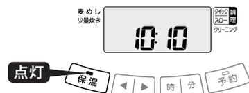
[時] を押している間、保温経過時間が24時間(24h)まで1時間単位で表示されます。24時間を超えると、「24」が点滅し、「h」が点灯します。
