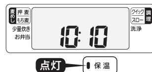
[時] を押している間、保温経過時間が24時間(24h)まで1時間単位で表示されます。24時間を超えると、「24」が点滅し、「h」が点灯します。
