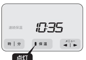
※保温ランプが点灯していないと、再加熱できません。点灯していないときは、〔保温〕キーを長押しする。（P.19参照）
