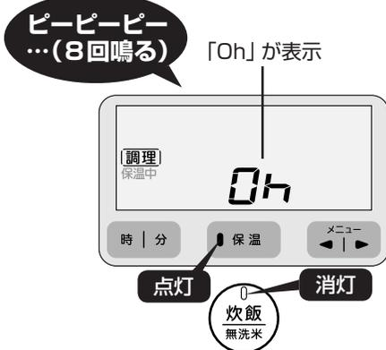
※調理が足りない場合は、保温ランプが点灯している状態で「時」キーを押して追加の調理時間を合わせ、「炊飯/無洗米」キーを押す。(最大30分を3回まで追加できます。)
