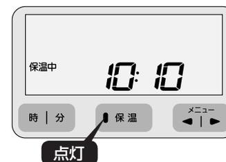
時キーを押している間、保温経過時間が24時間(24h)まで1時間単位で表示されます。24時間を超えると、「24」が点滅し、「h」が点灯します。
