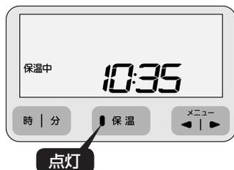
※保温ランプが点灯していないと、再加熱ができません。点灯していないときは、**保温** キーを長押しする。(P.19参照)
