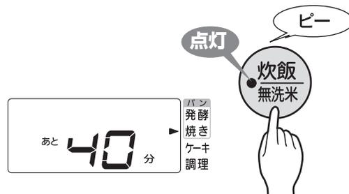
※ 焼上げ時間を40分以外に合わせる場合は、「焼き」を選択後、「時」(分)キーで時間を合わせ、「炊飯/無洗米」キーを押す。
