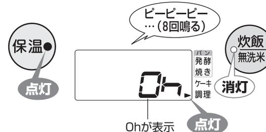
※ 調理が足りない場合は、保温ランプが点灯している状態で **[時]** キーを押して追加の調理時間を合わせ、**[炊飯/無洗米]** キーを押す。(最大30分を3回まで追加できます。)
