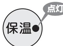
\* 保温ランプが点灯していないと、再加熱ができません。点灯していないときは、**[保温]** キーを押す。(P.14 参照)
