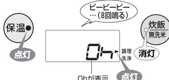
\* 調理が足りない場合は、保温ランプが点灯している状態で **時** キーを押して追加の調理時間を合わせ、**炊飯/無洗米** キーを押す。(最大30分を3回まで追加できます。)
