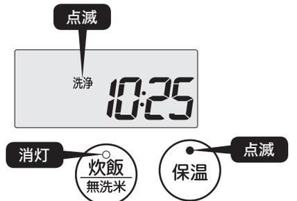
⑤ **取消** を押し、差込プラグを抜いて電源コードを収納する。
