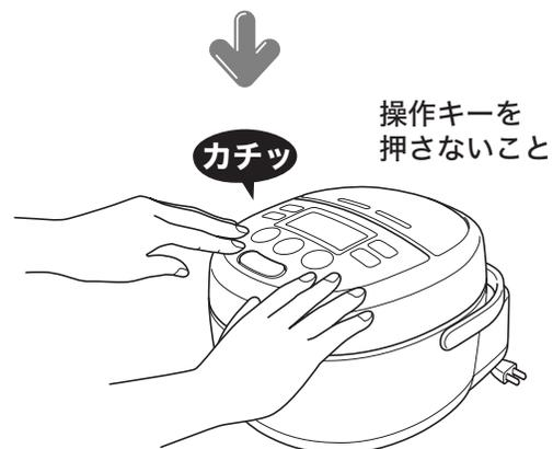
圧力式炊飯器は、内なべ内部の密閉度が高いため、ふたが閉まりにくい場合があります。必ずふたが確実に閉まっていることを確認してください。
