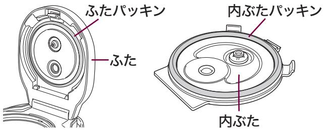
◆蒸気ふたセンサーパッキンがはずれたときは、パッキンの方向に注意して奥まではめ込む。(下図参照)蒸気もれなどの故障の原因。
