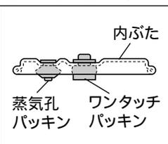
蒸気孔パッキンには、パッキンリングがついています。パッキンリングがはずれたときは、方向に注意して、図のように奥まできっちりとはめ込み、はずれないことを確認してください。
