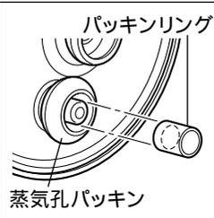
内ぶたは、ワンタッチパッキンをふた中央の突起に、蒸気孔パッキンを蒸気孔に合わせて、確実に取りつけてください。間違った位置で無理につけると、内ぶたが変形したり、ふきこぼれの原因になります。内ぶたをつけた後、ふたを閉めて、蒸気孔から蒸気孔パッキンの穴が見えることを確認してください。
