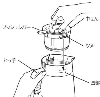
プッシュレバーととっ手の向きを合わせ、「カチッ」と音がして左右のツメがはまるまで確実に押し込む。
