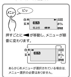
4 調節 キーを押して、 仕上り(標準・強・弱)を 選択する
