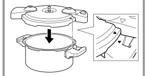
圧力ふたを、ふたとっ手の 印の方 向にまわして確実に固定する。
