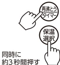
洗浄が開始されます。洗浄中は沸とう/カルキぬきランプと保温ランプが交互に点滅、表示部が下図のように移動して知らせます。その後洗浄の残時間の表示に切り替わります。
