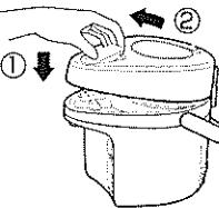
上ぶたを約45℃に開けて、上ぶた着脱レバーを押しながら、注ぎ口方向に引いて上に持ちあげます。
