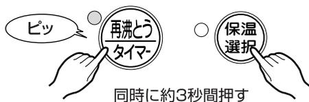
洗浄が開始されます。洗浄中は沸とうランプと保温ランプが交互に点滅、液晶表示が下図のように移動して知らせます。その後洗浄の残時間の表示に切り替わります。
