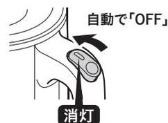
**6** 沸とうが完了すると、自動的にスイッチが「OFF」になる。沸とうランプが消灯していることを確認する。
