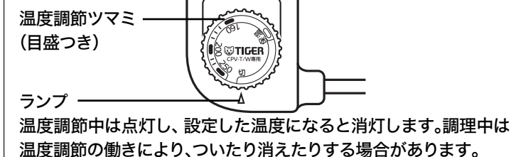
温度調節器の表示部
