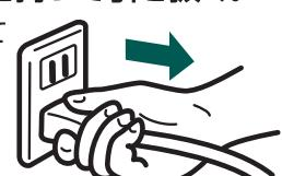
差し込みプラグを抜くときは、必ず差し込みプラグを持って引き抜く。
