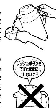
●注湯後は必ずプッシュボタンを再度押し、戻しておいてください。押し下げたままだと、万一ボットが倒れた場合にお湯が流れ出たり、保温(保冷)効力が低くなります。
