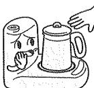
**禁止** 使用中や使用後しばらくは、サーバーの熱でトッププレートが熱くなっているので手をふれない
