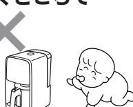
**接触禁止** 使用中や使用後しばらくは高温部(本体上部・吐出口・抽出口・蒸気孔・フィルター・サーバーなど)にさわったり、顔などを近づけない。
