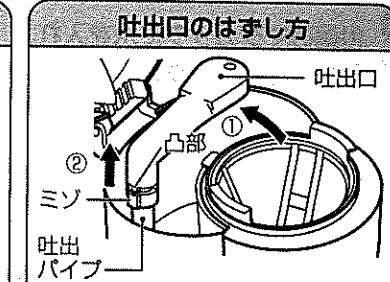
吐出口を向って右側へ回転させ、吐出口のミゾと吐出パイプの凸部を合わせて上へ引き抜きます。
