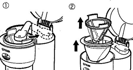
本体ふたを開け、吐出口を向って右側へ回転させ、フィルター、フィルター受けを取り出します。
