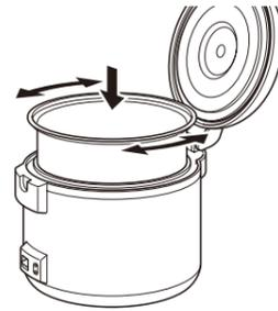
Déposez le panier cuit-vapeur à l'intérieur du cuiseur, en contact direct avec la plaque chauffante. Pour ce faire, il vous suffit de faire pivoter le panier de gauche à droite jusqu'à ce qu'il soit fermement en place.
